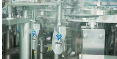
膜溶解法で水素を溶かし込んだ後、充填工程では高い圧力を保ったまま一気に充填。アルミパウチは充填前に中の余計な空気を抜いているのもこだわりです。
