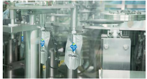
充填工程では溶存工程の高い圧力を保ったまま一気に充填。アルミパウチは充填前に中の余計な空気を抜いているのもこだわりです。
